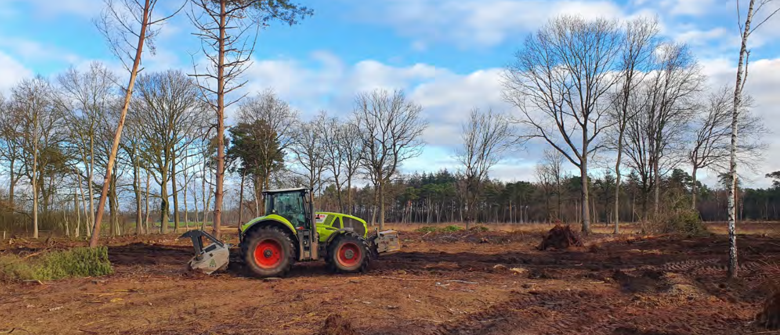
Bosfrezen: verwijderen van wortels, stronken en takken
