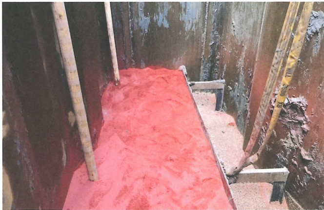
Rood gekleurd zand aangebracht als tracermateriaal.
